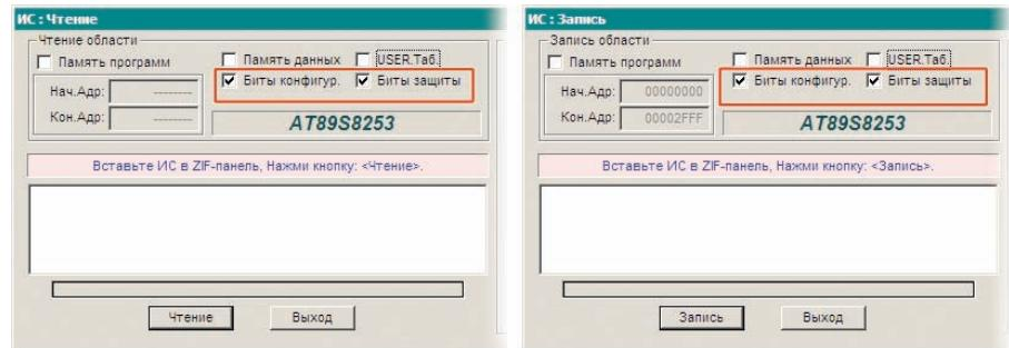
ции записи информации на устройство: в окне программирования устройства будут доступны идентичные флаги, включающие/отключающие запись конкретных областей памяти и настроек ИС. Подробнее об операциях чтения/записи можно узнать из п.3.6.
