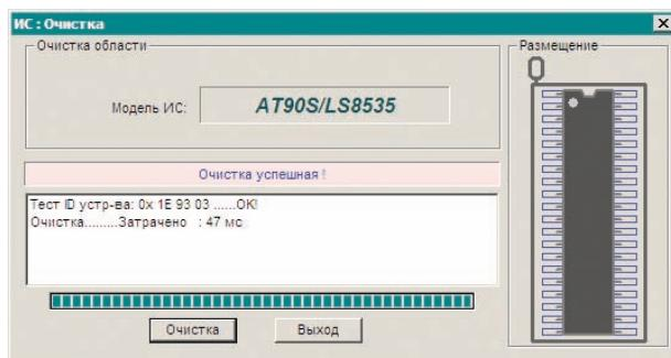
**Проверка** очистки памяти устройства. Доступна из меню «**Устройство/Тест очистки**» или по соответствующей кнопке на панели инструментов. Проверку чистоты можно выполнять для широкой номенклатуры устройств, как однократно так и многократно программируемых. Для устройств без возможности стирания выполняется проверка на принципиальную пригодность микросхемы к дальнейшему программированию.
