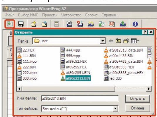
\*.bin (двоичный файл с нужным набором байт), \*.hex (Intel-HEX файл, текстовый, символы которого означают 16-ричные значения адресов, данных, построчных контрольных сумм символьного дампа. При этом используется прямой порядок байт в слове: младший байт на младшем адресе), \*.jed (JEDEC-файл для логических матриц).
