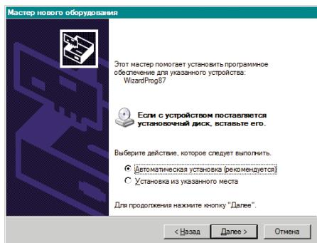
В подсказках мастера следует отказаться от подключения к интернету для обновления драйверов, а затем выбрать рекомендованную «Автоматическую установку». Дождавшись окончания активизации и завершив работу мастера можно немедленно переходить к работе с программатором. При успешно завершенной инсталляции мигающий желтый индикатор гаснет.
