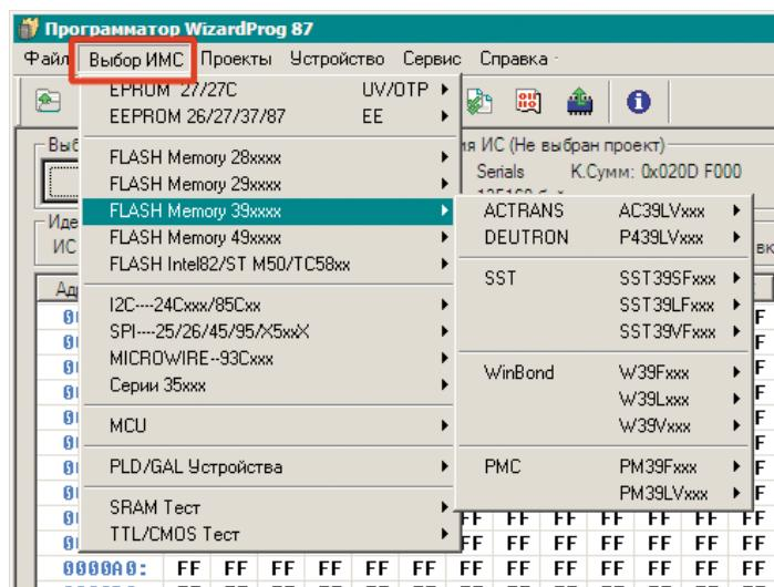
Элементы меню последнего уровня, перечисляющие конкретные устройства, могут содержать отличительные признаки разнообразной корпусовки (DIP/PLCC/SOP/TSOP) а также иные особенности в пределах одного и того же номинала. Также в меню разных уровней применяются логические группировки однородных номиналов и их сокращения. При поиске конкретной ИС следует внимательно отнестись к подобным вариациям.
